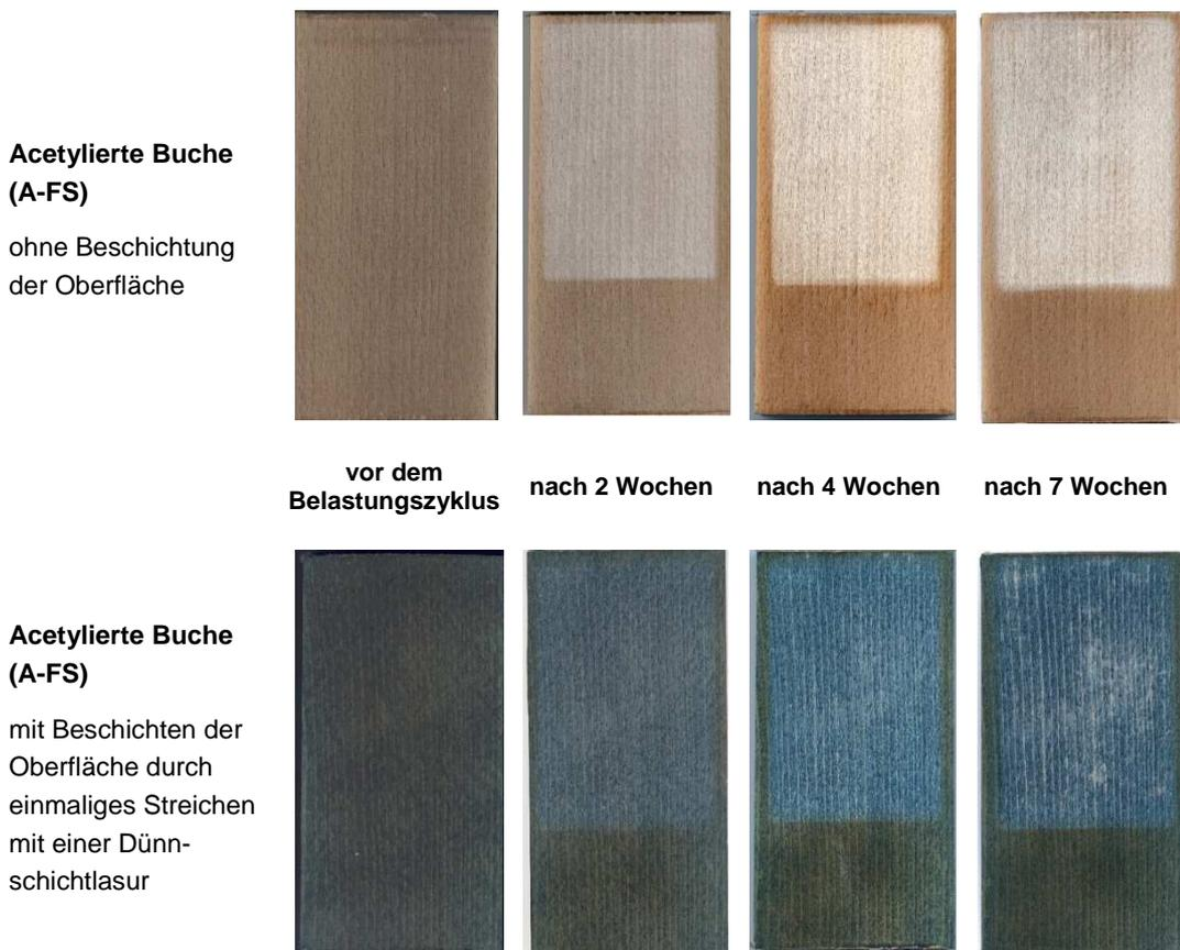
Abbildung 98: Künstliche Schnellbewitterung mittels Q-UV an acetylierter Buche
