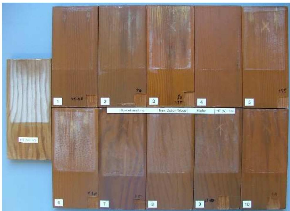
**Abbildung 99:** Im Q-UV-Gerät bewitterte Proben des vergüteten Holzes HT(N)-PS mit den Beschichtungen entsprechend Tabelle 18
