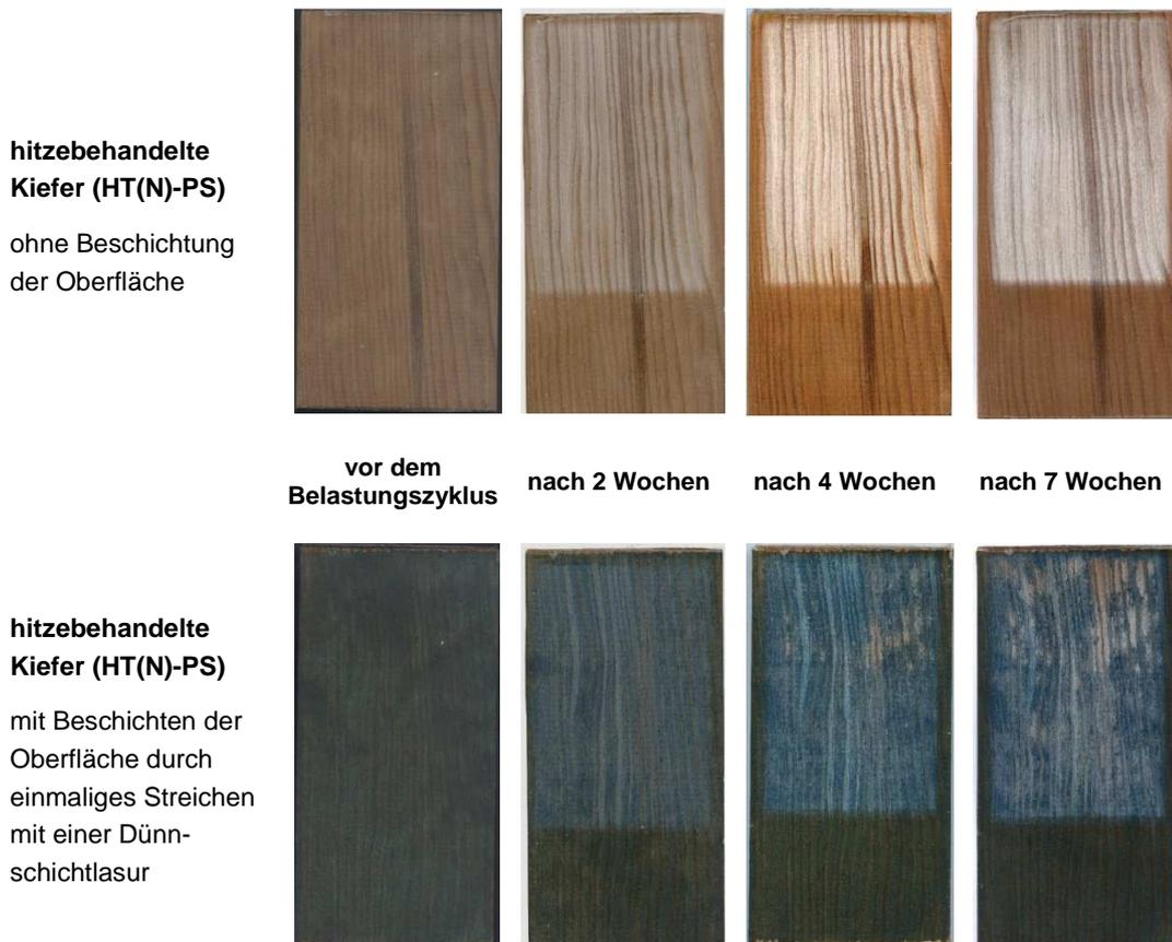
Abbildung 90: Künstliche Bewitterung mittels Q-UV an hitzebehandelter Kiefer (HT(N)-PS)
