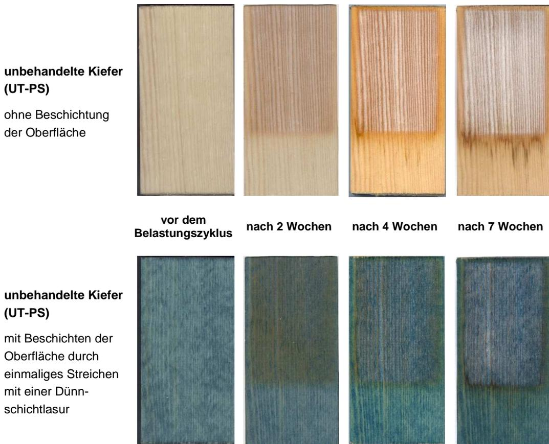
Abbildung 89: Künstliche Bewitterung mittels Q-UV an unbehandelten Kiefernholzproben
