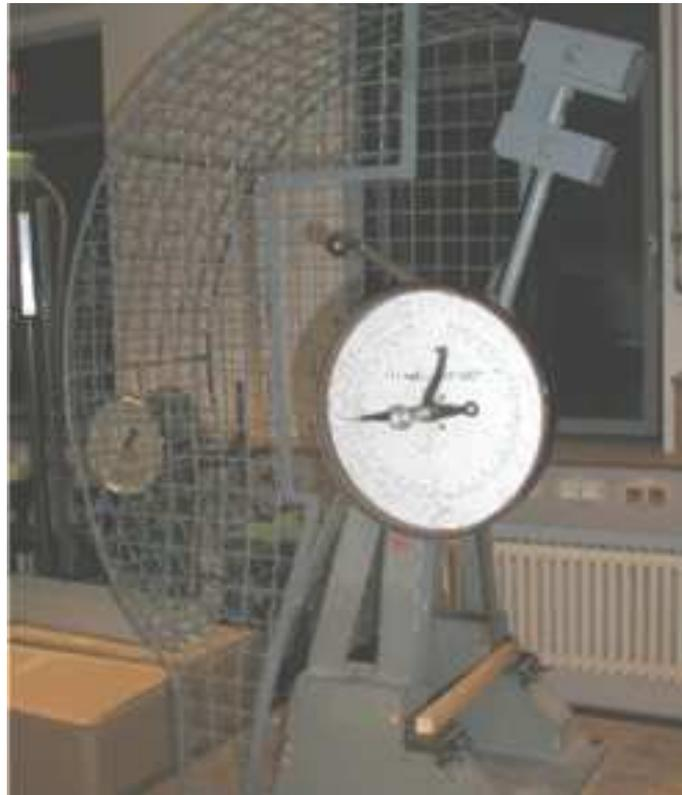
Abbildung 73: Eingelegter Probestab zur Ermittlung der Bruchschlagarbeit
