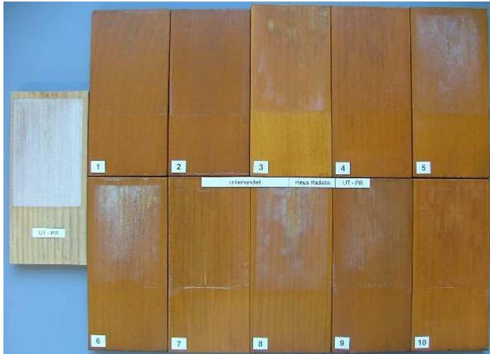
Abbildung 108: Im Q-UV-Gerät bewitterte Proben des vergüteten Holzes UT-PR mit den Beschichtungen entsprechend Tabelle 18
