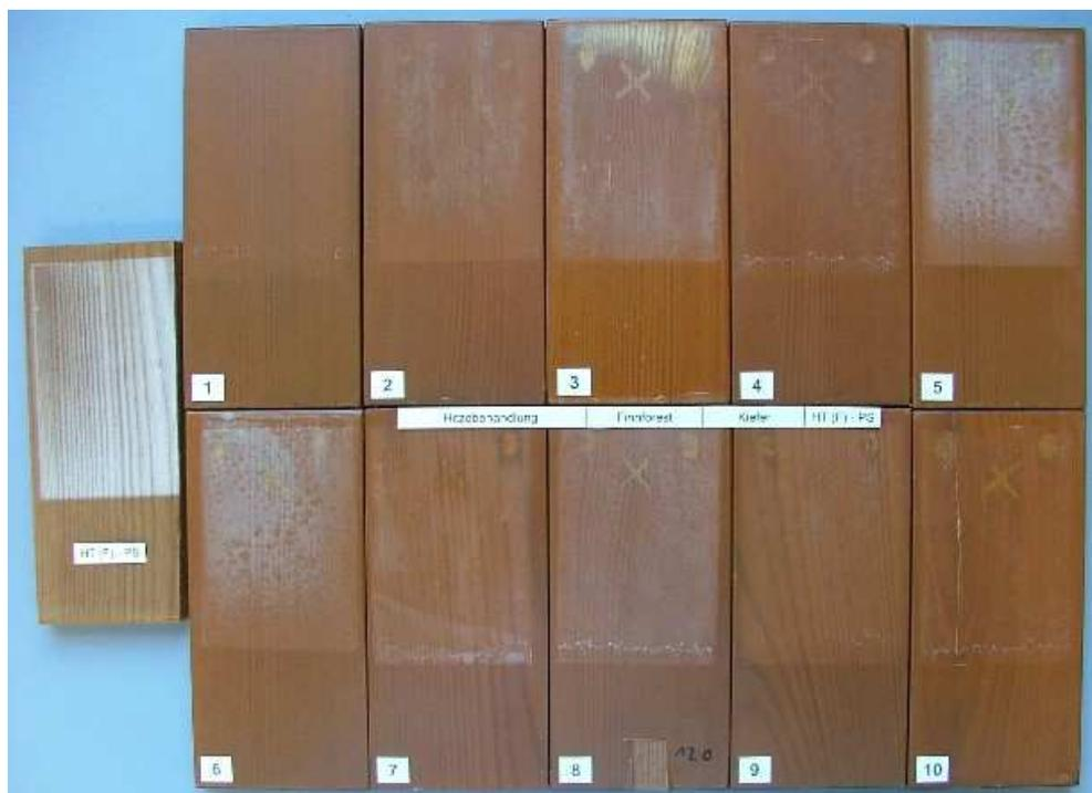
Abbildung 101: Im Q-UV-Gerät bewitterte Proben des vergüteten Holzes HT(F)-PS mit den Beschichtungen entsprechend Tabelle 18
