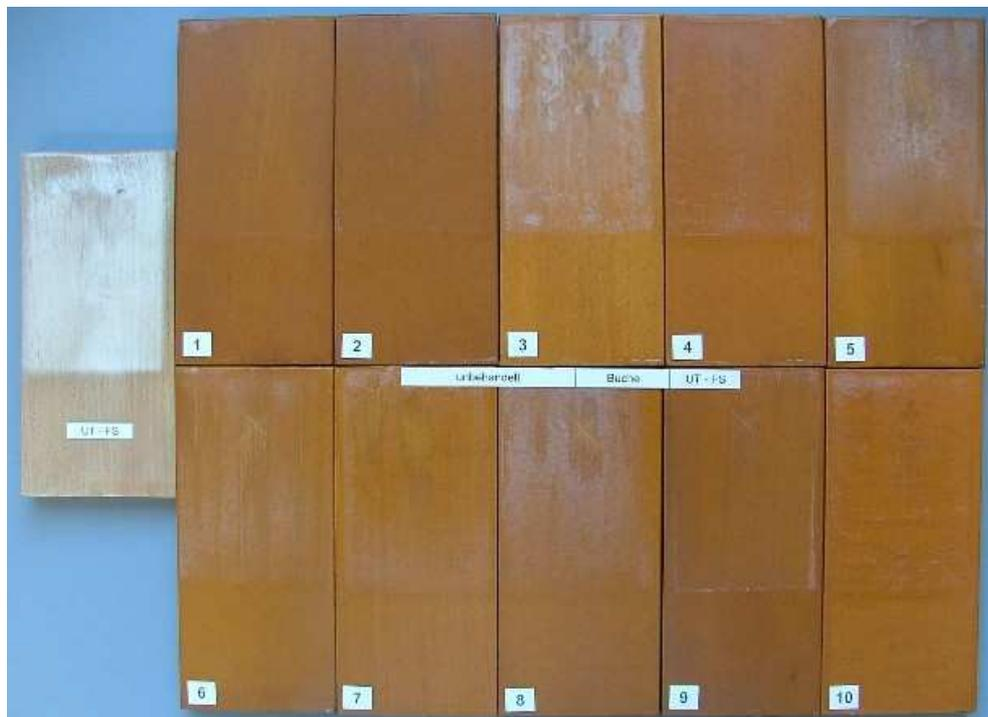
Abbildung 107: Im Q-UV-Gerät bewitterte Proben des vergüteten Holzes UT-FS mit den Beschichtungen entsprechend Tabelle 18
