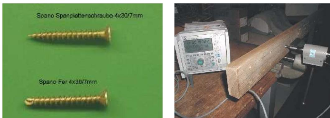
Abbildung 81: Für die Versuche verwendete Schraubentypen (links);
