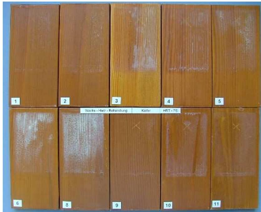
**Abbildung 104:** Im Q-UV-Gerät bewitterte Proben des vergüteten Holzes HRT-PS mit den Beschichtungen entsprechend Tabelle 18
