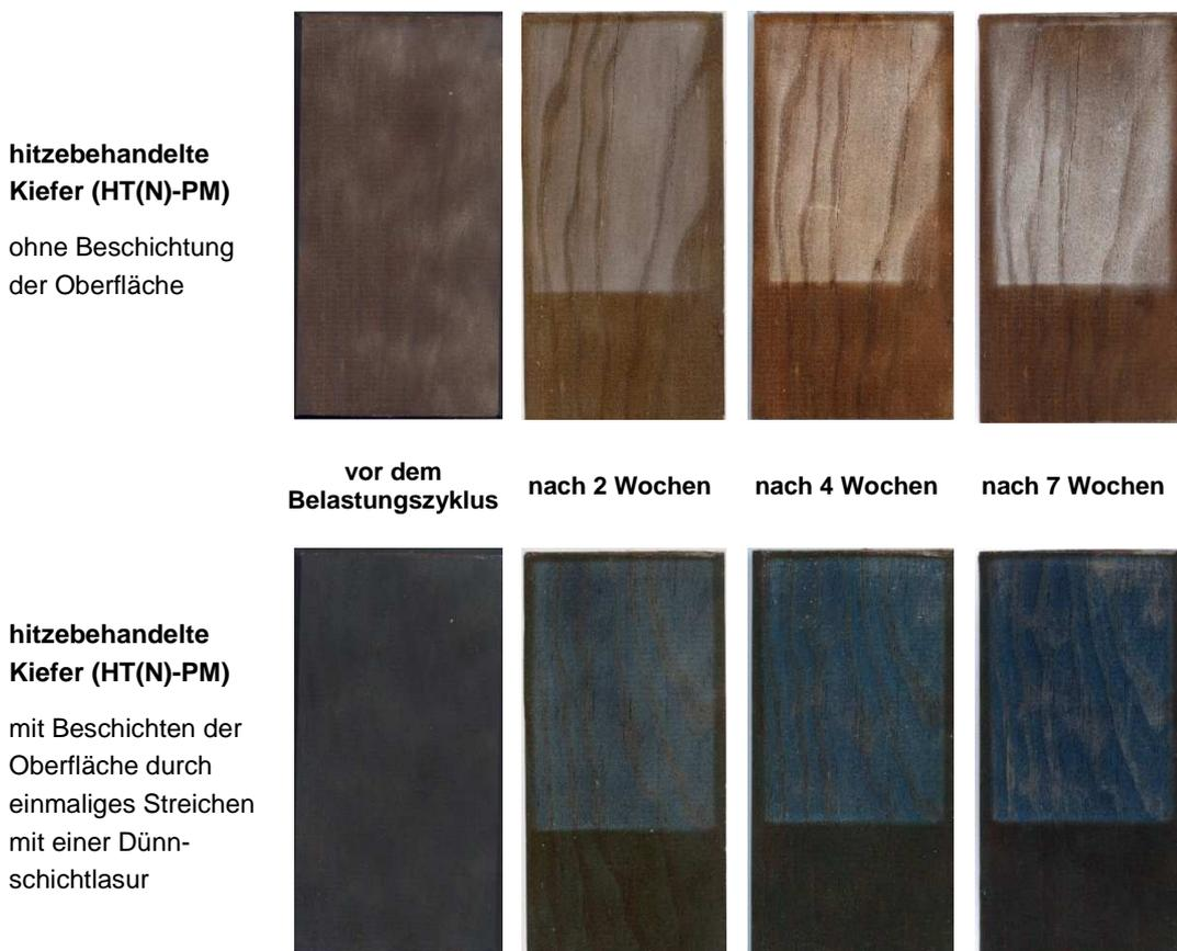
Abbildung 91: Künstliche Bewitterung mittels Q-UV an hitzebehandeltem Holz der Seekiefer
