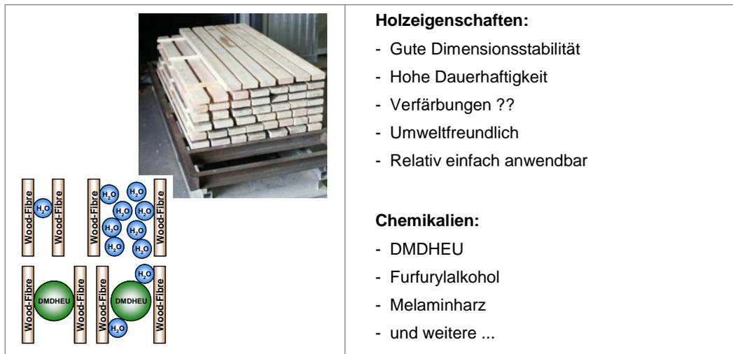
Abbildung 25: Beschreibung des Vergütungsverfahrens mit polymerisierbaren Chemikalien
