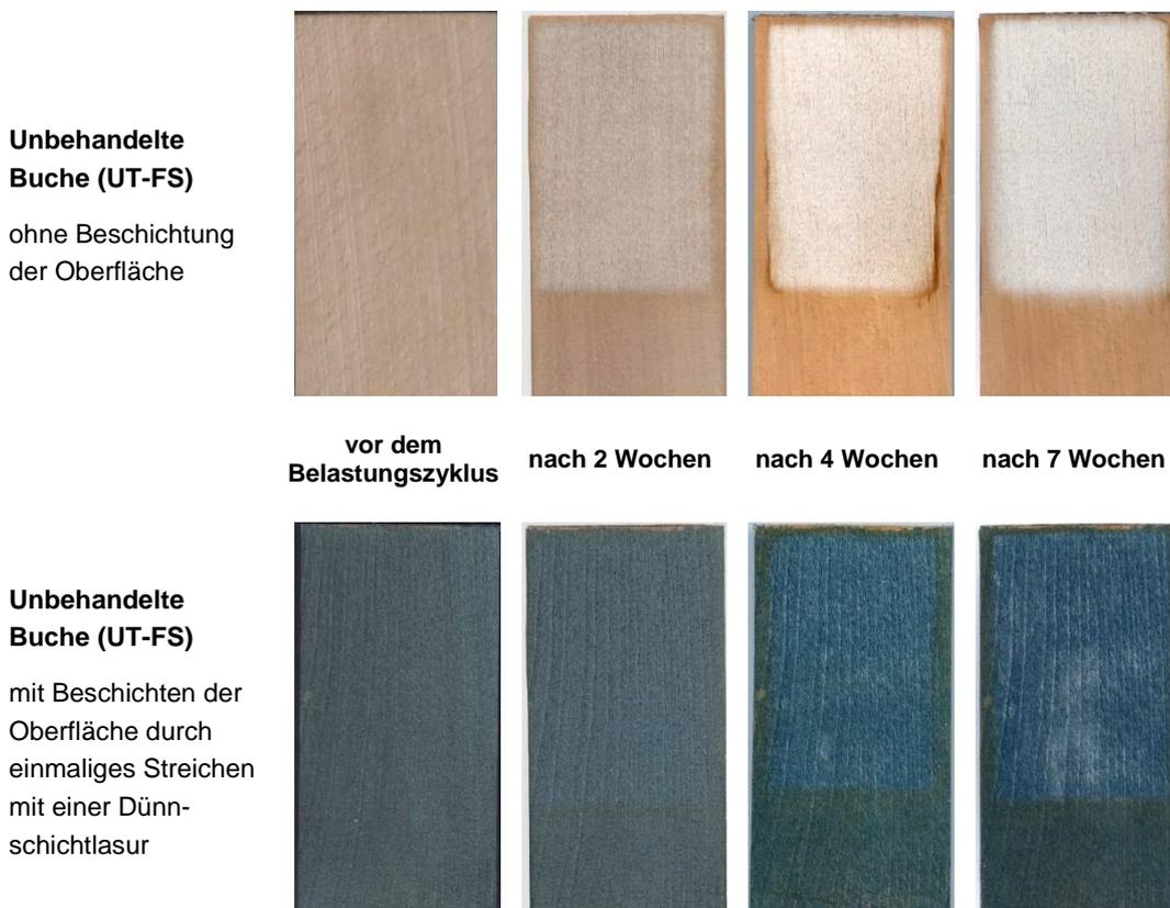
Abbildung 97: Künstliche Schnellbewitterung mittels Q-UV an unbehandelter Buche
