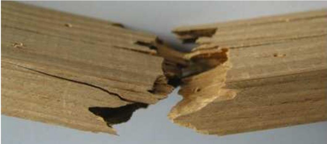
**Abbildung 66:** Typisches Bruchbild bei der Ermittlung der Biegefestigkeit
