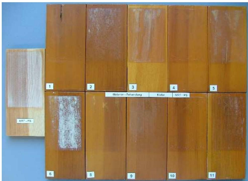
Abbildung 103: Im Q-UV-Gerät bewitterte Proben des vergüteten Holzes MRT-PS mit den Beschichtungen entsprechend Tabelle 18
