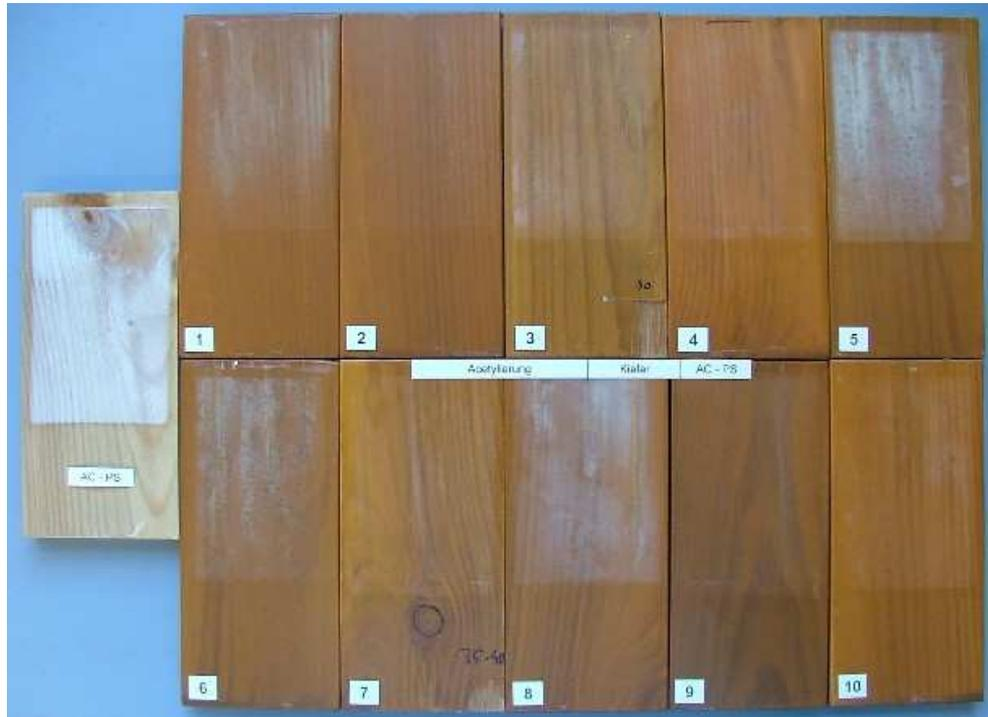
Abbildung 106: Im Q-UV-Gerät bewitterte Proben des vergüteten Holzes A-PS mit den Beschichtungen entsprechend Tabelle 18
