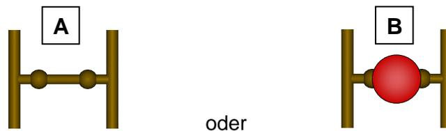
Abbildung 20: Vernetzung von Hydroxylgruppen durch Eigenkondensation [A] oder reaktive Imprägniermittel [B]
