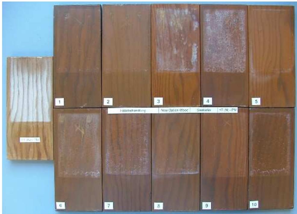
Abbildung 100: Im Q-UV-Gerät bewitterte Proben des vergüteten Holzes HT(N)-PM mit den Beschichtungen entsprechend Tabelle 18
