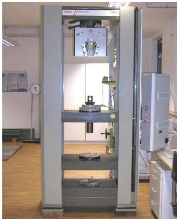
Abbildung 64: Durchführung der Prüfungen an einer Zwick-Universalprüfmaschine Typ 1485
