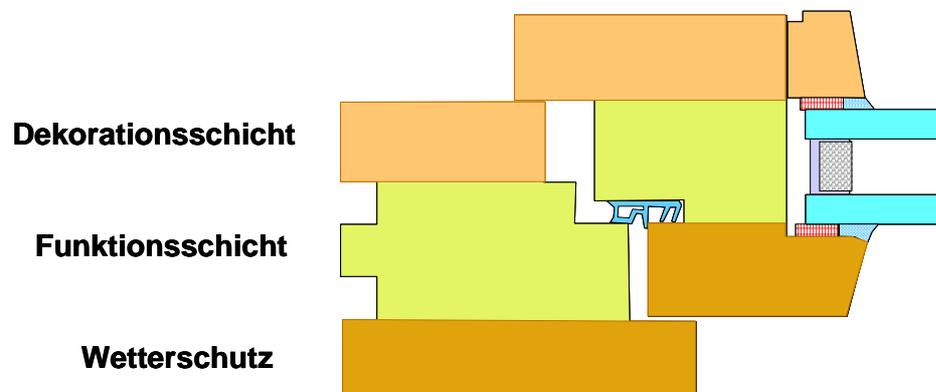
Abbildung 140: Aufbau eines Profilquerschnittes für Fenster mit Optimierung der Eigenschaften der einzelnen Schichten
