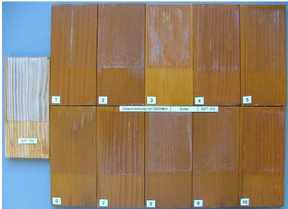
Abbildung 102: Im Q-UV-Gerät bewitterte Proben des vergüteten Holzes DRT-PS mit den Beschichtungen entsprechend Tabelle 18
