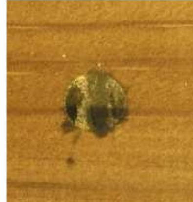
Abbildung 77: Eingelegter Probekörper zur Ermittlung der Brinellhärte (links); „Markierung“, die die Prüfkugel in der Probe hinterlassen hat (rechts)
