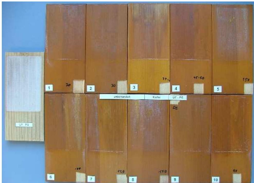
Abbildung 109: Im Q-UV-Gerät bewitterte Proben des vergüteten Holzes UT-PS mit den Beschichtungen entsprechend Tabelle 18
