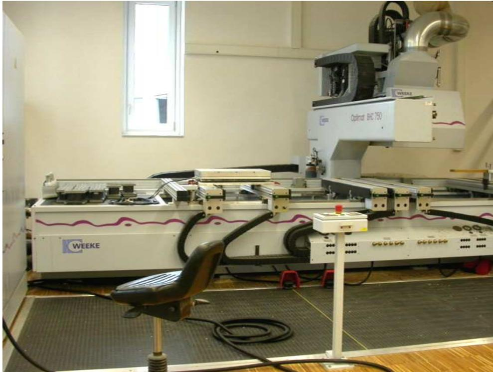
Abbildung 111: Bearbeitungszentrum der Fa. Leitz für die Durchführung der Bearbeitungsversuche
