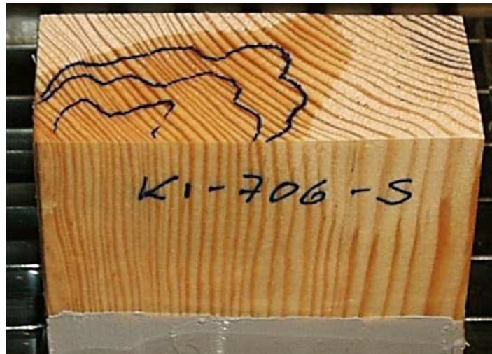
Abbildung 30: Holzprobe nach der Bestimmung des Wasseraufnahmekoeffizienten mit Kennzeichnung der Bereiche des Wasserdurchtritts an der Oberfläche nach 5, 10, 15 und 30 Minuten
